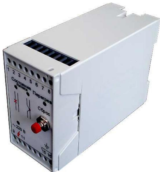
Блок тепловой защиты предназначен для защиты от чрезмерного повышения температуры обмоток двигателей как при медленно нарастающих, так и быстро нарастающих тепловых перегрузках. БТЗ является частью системы температурной защиты, включающей в себя температурный датчик (терморезистор), контактное (ПМЛ) или бесконтактное (ФЦ-0620, ПБР и т.д.) коммутирующее устройство для отключения обмоток электродвигателя.
