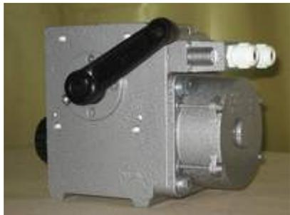
Электроприводы МЭО или исполнительные Механизмы Электрические Однооборотные используются для перемещения рабочих элементов регулирующей и запорно-регулирующей трубопроводной неполноповоротной арматуры: шаровых кранов, дисковых затворов в системах АСУ ТП в автоматическом, дистанционном или ручном режимах в любом положении. Применяются в различных отраслях: энергетике, судостроении, ЖКХ, бумажно-целлюлозной и пищевой промышленности, в системах кондиционирования воздуха.
