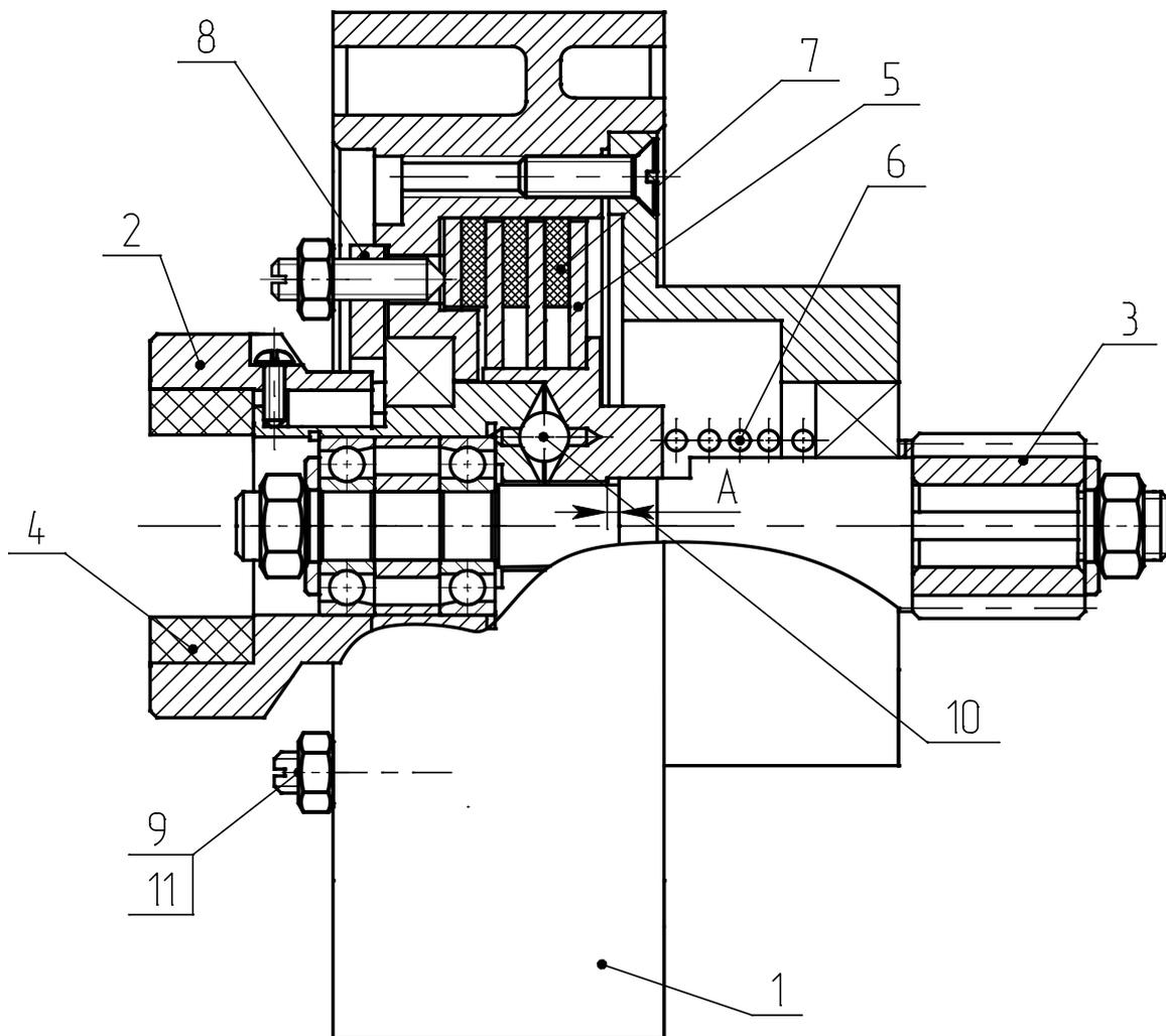
1- корпус, 2- полумуфта, 3- шестерня, 4- сухарь, 5 – тормозной диск, 6- пружина,
