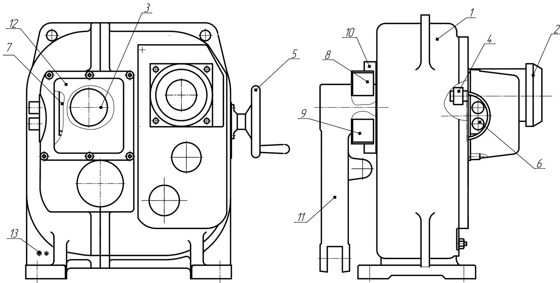
1-редуктор; 2-электродвигатель; 3-блок сигнализации положения или БКВ; 4-тормоз; 5- привод ручной;
