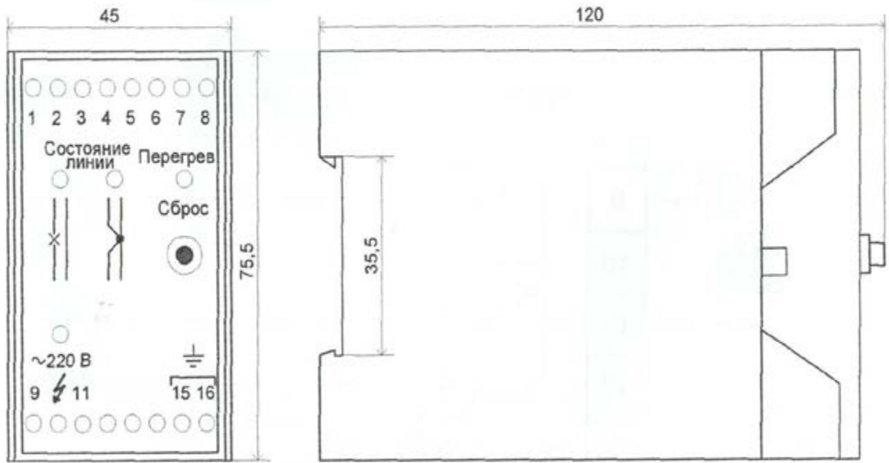
1,2,3,4 - клеммы для подключения цепей управления двигателем
